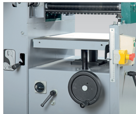
Zdvih protahovacího stolu se stupnicí Lifting of thickening table with indication Dickentischhub mit Skala Elevación de la mesa para regruesar con escala Monte et baisse avec indication
